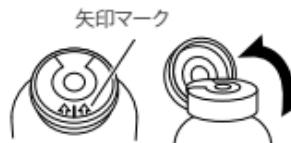
2. 片側（左右どちらでもよい）から、アルミ部分を巻き込むようにひねりながら回して、上フタをはがします。
