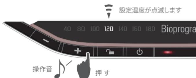
設定の約5秒後ロック状態になり温度表示ランプが点滅し、設定温度に達すると点灯に変わります。
